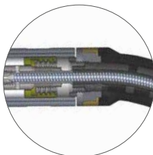
Monoblockdüse: doppelte Düsensitzisolation mit Glasgewebe und PTFE
